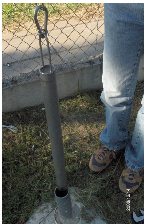
Toma de muestra de agua subterránea
