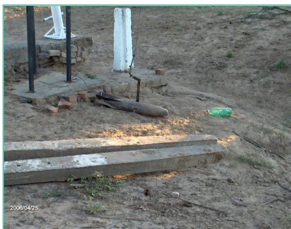
Figura 20 Molinete. Con este dispositivo se calcula la velocidad del agua en distintos puntos de un tramo de río y con ello se estima el caudal que está circulando por este tramo.
